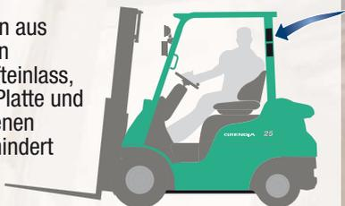
Bei Staplern ohne diese Funktion (wie dem unten) wird Schmutz in den Motorraum gesaugt und mit dem Kühlerlüfter in die Luft verteilt. **GRENDIA**s Belly Seal verhindert dies und schützt so Ihre Mitarbeiter und Ihr Lager.
